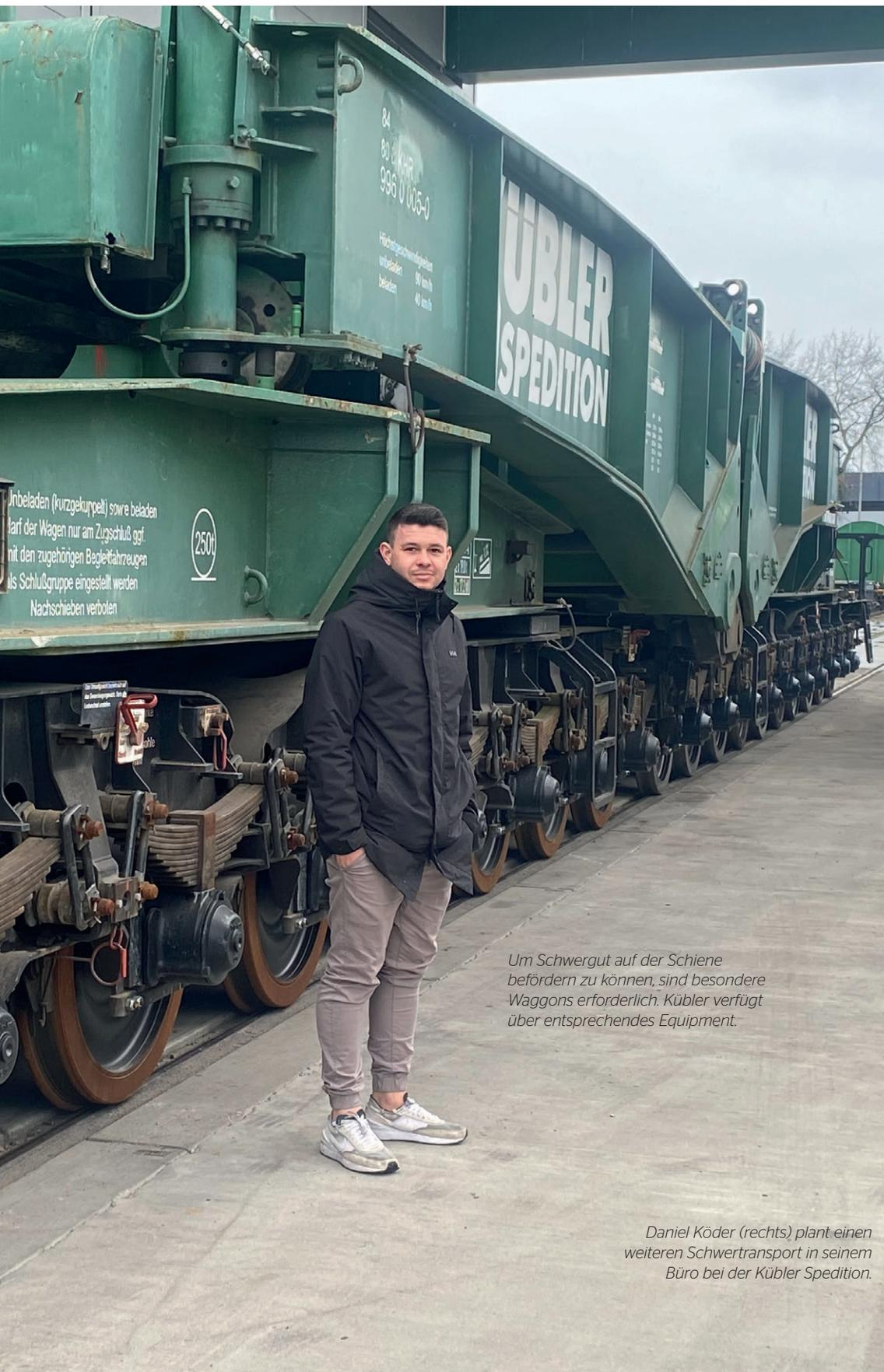
*Um Schwergut auf der Schiene befördern zu können, sind besondere Waggons erforderlich. Kübler verfügt über entsprechendes Equipment.*
