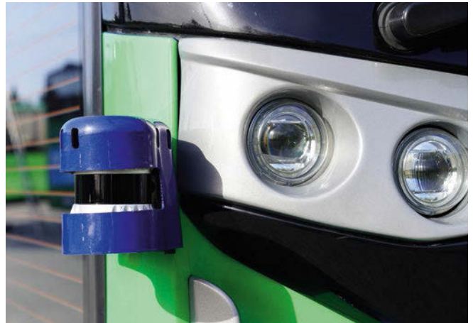
Abb. 2: Gesteuert wird der hochautomatisierte Elektrobus u.a. mit Laserscanning.
