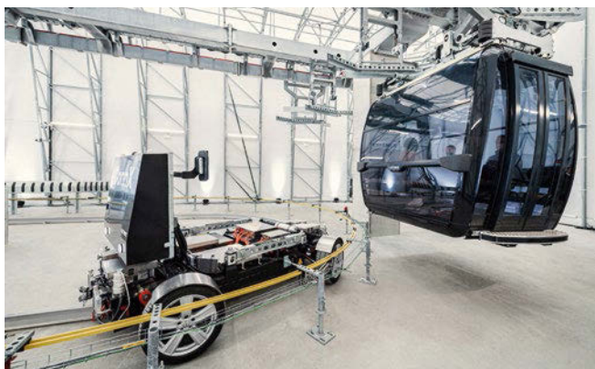
Abb. 5: Demonstrationsanlage für das System ConnX: Wechsel von Seilbahngehänge auf ein Fahrgestell. Quelle: Leitner GmbH / SPA
