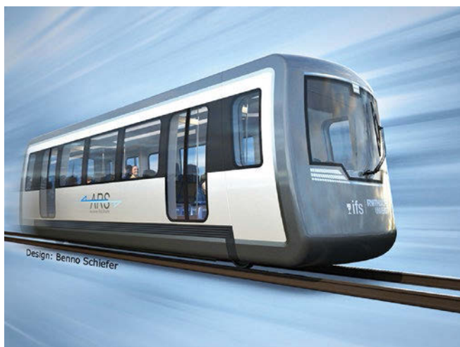
Abb. 1: Der ARS hat etwa die Länge eines Standardlinienbusses und bietet Platz für ca. 90 Passagiere. Quelle: RWTH Aachen
