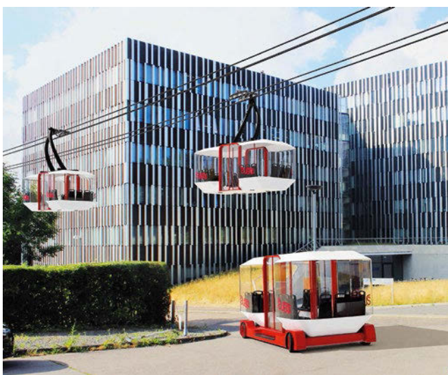
Abb. 3: Beim System upBUS soll als erstes die Kombination aus Seilbahn und autonom verkehrenden Shuttles in die Praxis umgesetzt werden. Quelle: RWTH Aachen
