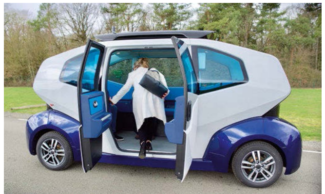
Abb. 2: Im Project FLEXY sollen die Milla PODs als Hybrid-Fahrzeuge mit Spezialrädern auch auf einer Nebenstrecke der SNCF fahren können. Quelle: MILLA
