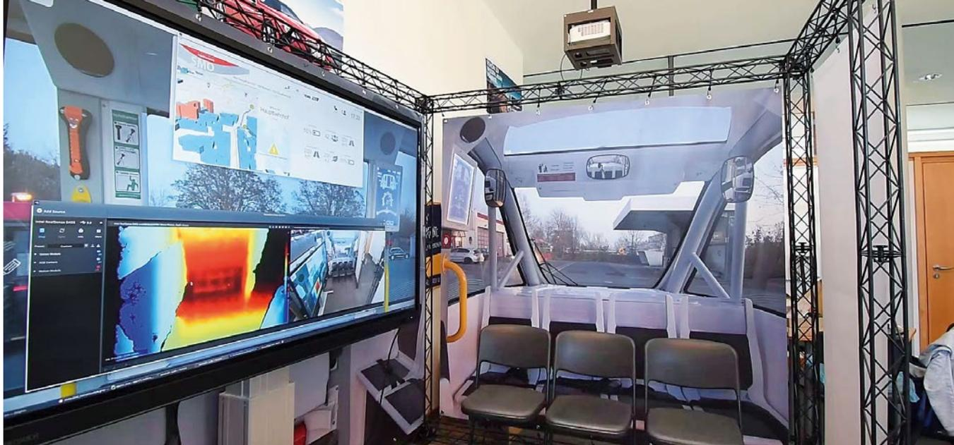
Abb. 1: Im Demonstrator an der iisys werden Eye-Movements und Hautwiderstand erkannt.
