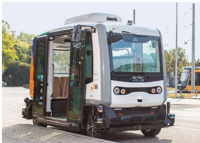
Abb. 1: Der EVA-Shuttle in Karlsruhe bewegt sich nicht auf einer virtuellen Schiene, sondern frei zwischen den Fahrbahnen.
