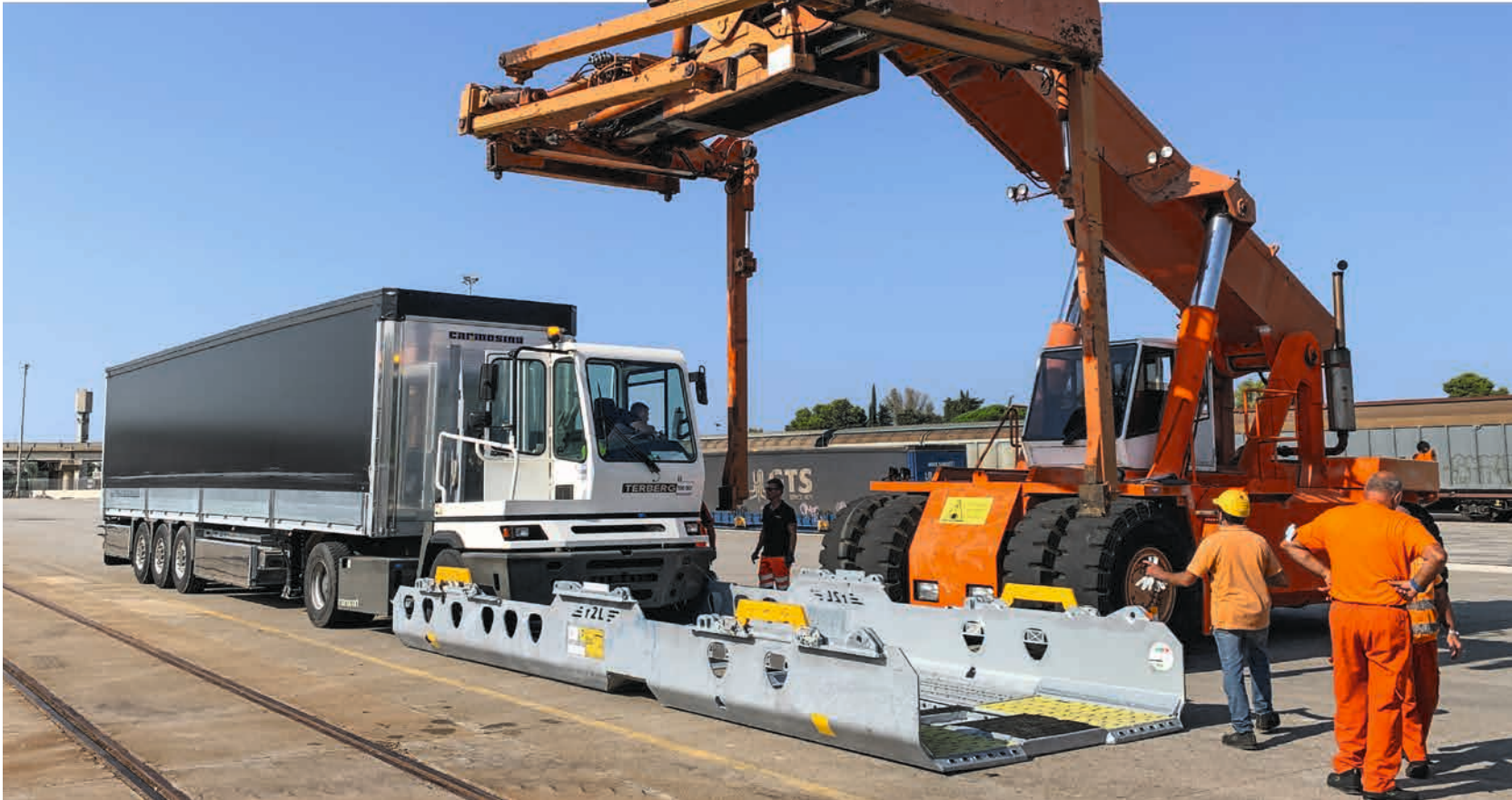
Der Trailer wird in einen R2L-Korb rangiert. Die wannenförmige Umschlaghilfe sorgt für die nötige Stabilität, so dass der Auflieger auch vertikal auf einen Waggon umsteigen kann.
