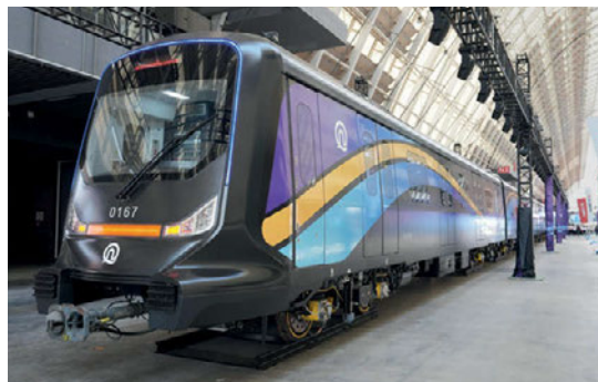
Das CFK-Fahrzeug Cetrovo 1.0 ist inzwischen in Betrieb – den Prototypen haben CG Rail aus Dresden und CRRC 2018 auf der InnoTrans vorgestellt.
